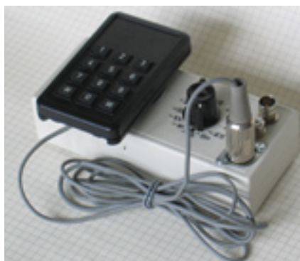
Fig.1. DTMF Level Tester
